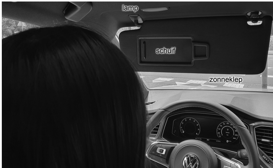
zonneklep omlaag en schuif dicht: de lamp brandt niet
